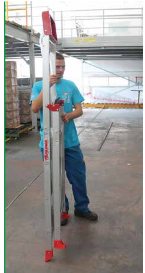
Złożone schody SGP zajmują niewiele miejsca. The SGP step ladder occupies very little space when closed.
