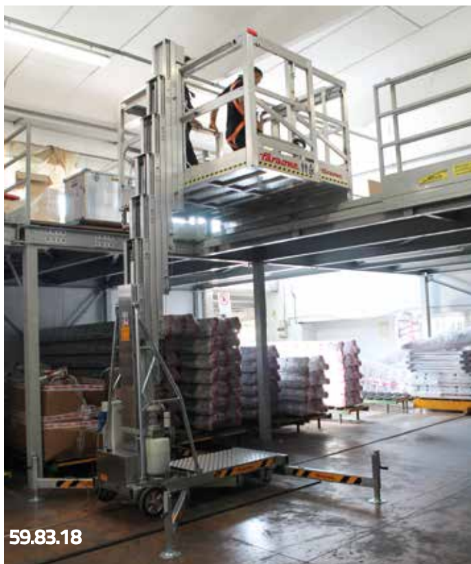
Platforma z zejściem na wysokości dla 2 operatorów. Posiada homologację TÜV. Platform for exit at height for 2 operators. Homologated by the TÜV.
