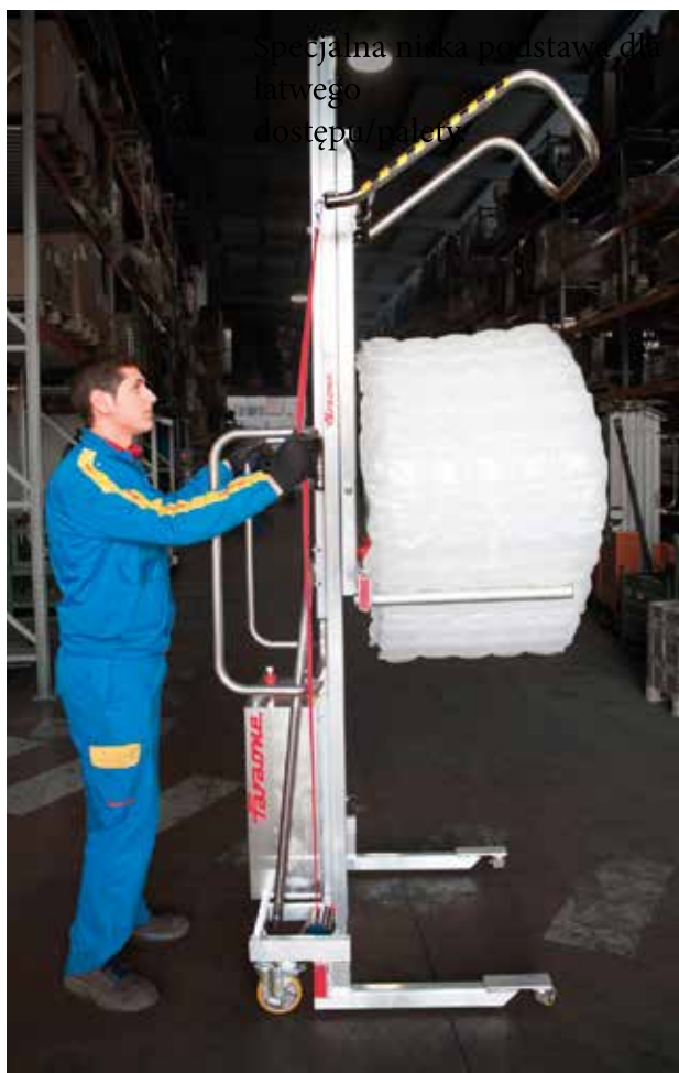
HW.I z HW.BR, ramię do pobierania szpul, uruchamiane z dołu HW.I with HW.BR, boom to pick up reels, driven from below.
