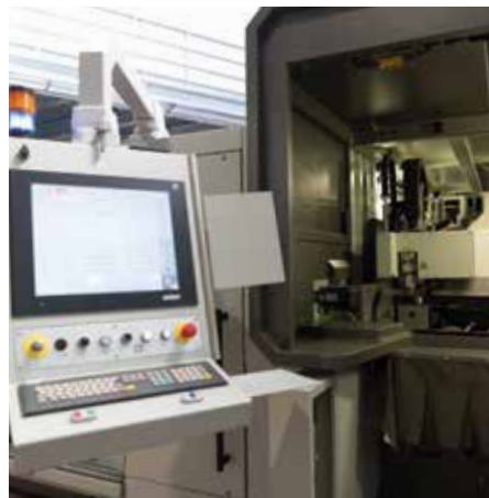
Maszyna do precyzyjnego cięcia laserowego High precision laser cutting
