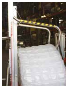
HW.BR Ramię do blokowania szpul, uruchamiane z dołu. Boom to block reels, driven from below.
