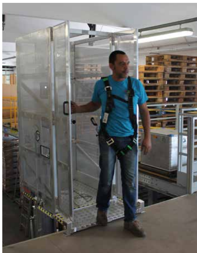
Platforma z zejściem na wysokości dla 2 operatorów. Posiada homologację TÜV. Platform for exit at height for 2 operators. Homologated by the TÜV.
